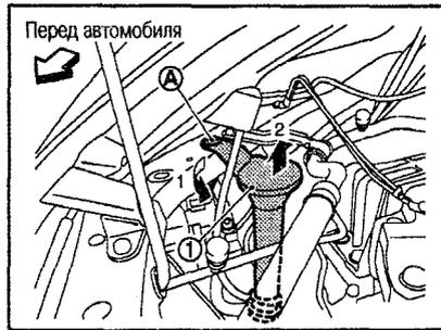
7. Отсоедините разъем от выключателя контрольной лампы низкого уровня моющей жидкости.
